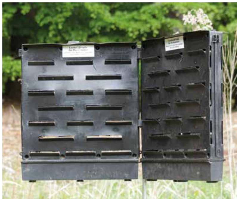
Abbildung 33: In den Borkenkäferfallen befinden sich ein Duftstoff, der die Käfer anlockt. Dadurch kann man die lokale Populationsgröße abschätzen, nicht aber den Bestand signifikant reduzieren. (Foto: H. Kirchmeir)
