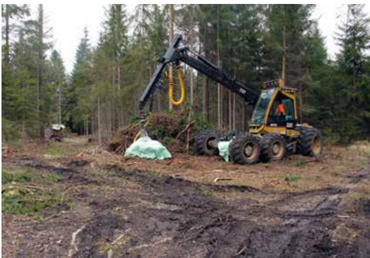
Abbildung 17: Schwere Holzerntemaschinen verursachen Bodenverdichtung und führen damit zu verringertem Wurzelwachstum. (Foto: H. Kirchmeir)
